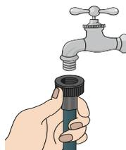
Utilize a conexão 90° para ligar no aparelho e a conexão reta para ligar na fonte de água.
